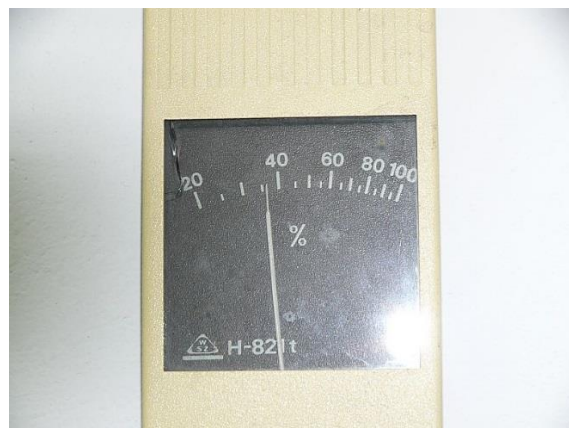
Fot. 8. Wilgotność pomieszczenia magazynowego w piwnicy ganku (nie jest to wilgotność powierzchni przegrody !). h_i = 35\% . Stan na dzień : 02.08.2017 r.
